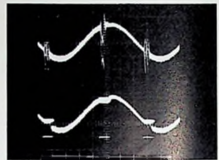
Bild 3. Zündfunkenstörung auf einem Tonsignal (oben). Ausgestastete Störung mit eingeblendetem Ersatzsignal (unten); darunter Triggerimpuls zur Steuerung der Torschaltung (Bild Philips)
